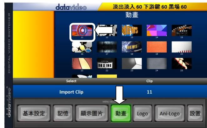
**提示:** 多媒體檔案管理軟體可將 bmp/png/jpg 檔案轉換成 pic 檔案格式。您只需要給多媒體檔案管理軟體一個檔案儲存位置的起始點，之後軟體就會開始將所有檔案串聯成一個動畫檔案。
