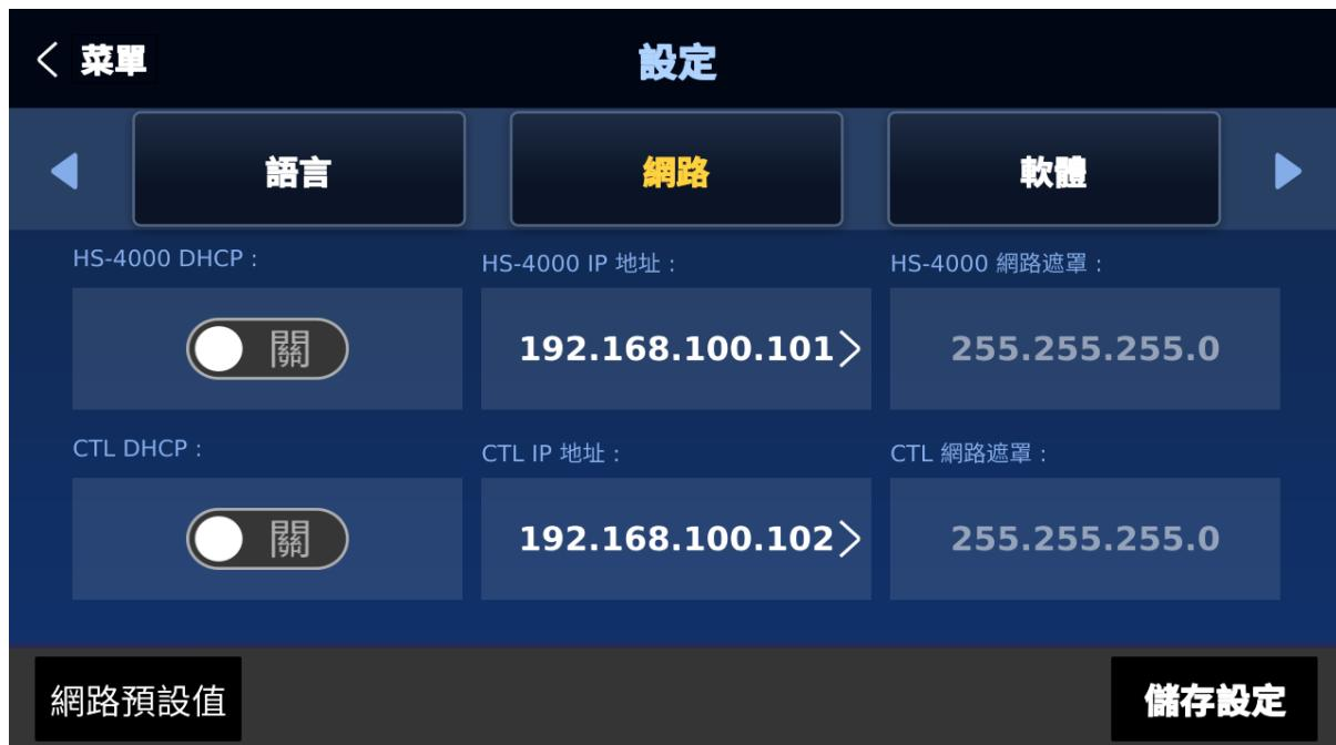
**DHCP**：網路連線模式可設定為 **DHCP** 或靜態 IP。預設連線模式為靜態 IP(DHCP 為關閉狀態)。導播機主機和控制面板的 IP 地址分別為 **192.168.100.101** 及 **192.168.100.102**。
