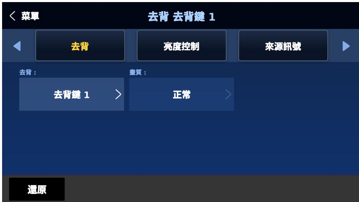
4. 在「亮度控制」選項內，選擇「亮度」和「關鍵訊號」將亮度去背效果套用到所連接的輸入畫面。亮度去背移除圖像的背景，在這個案例，移除的是圖像黑色的成分。
