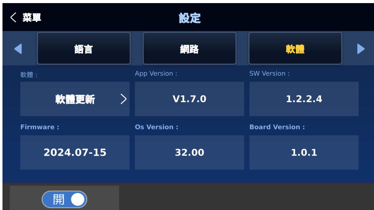
「軟體」選單內的「軟體更新」可讓您在插入存有最新韌體檔案的 USB 硬碟時啟動軟體更新的流程。軟體更新細節可參考[附錄五](#)。選單內另外也顯示目前所安裝的各項軟體版本。
