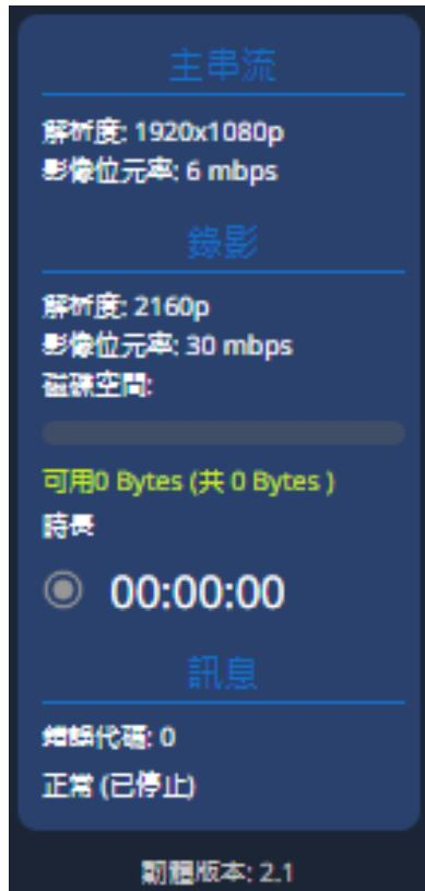
訊息板顯示串流影像的解析度及位元率(串流與錄影)、SD 卡訊息(總硬碟容量、剩餘容量及已錄製的影片長度)、錯誤訊息(橘色字體)及裝置狀態(白色字體)。
