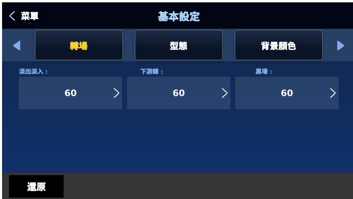
使用者可在「轉場」子選單設定轉場速度。轉場速度以幀率計算。可設定的轉場方式有淡入淡出(MIX)，下游鍵(DSK)，及黑幕轉場(FTB)。
