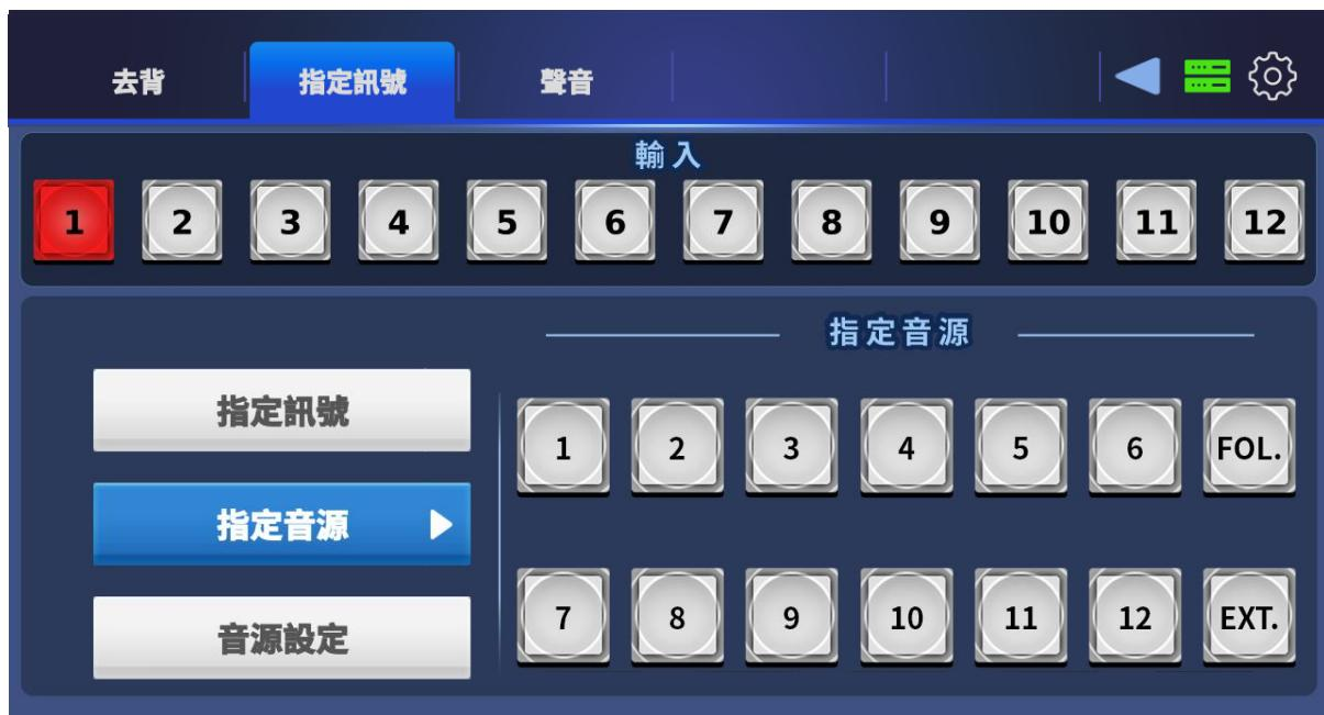
點選音源設定即可調整音源的**音量**及**延遲**。
