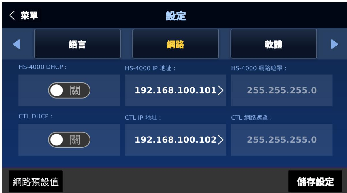
3. 看到儲存成功的提示後，將 HS-4000 重新開機，開機後再將導播機連接到路由器或網路即可獲取 DHCP 伺服器所指派的 IP 位址。
