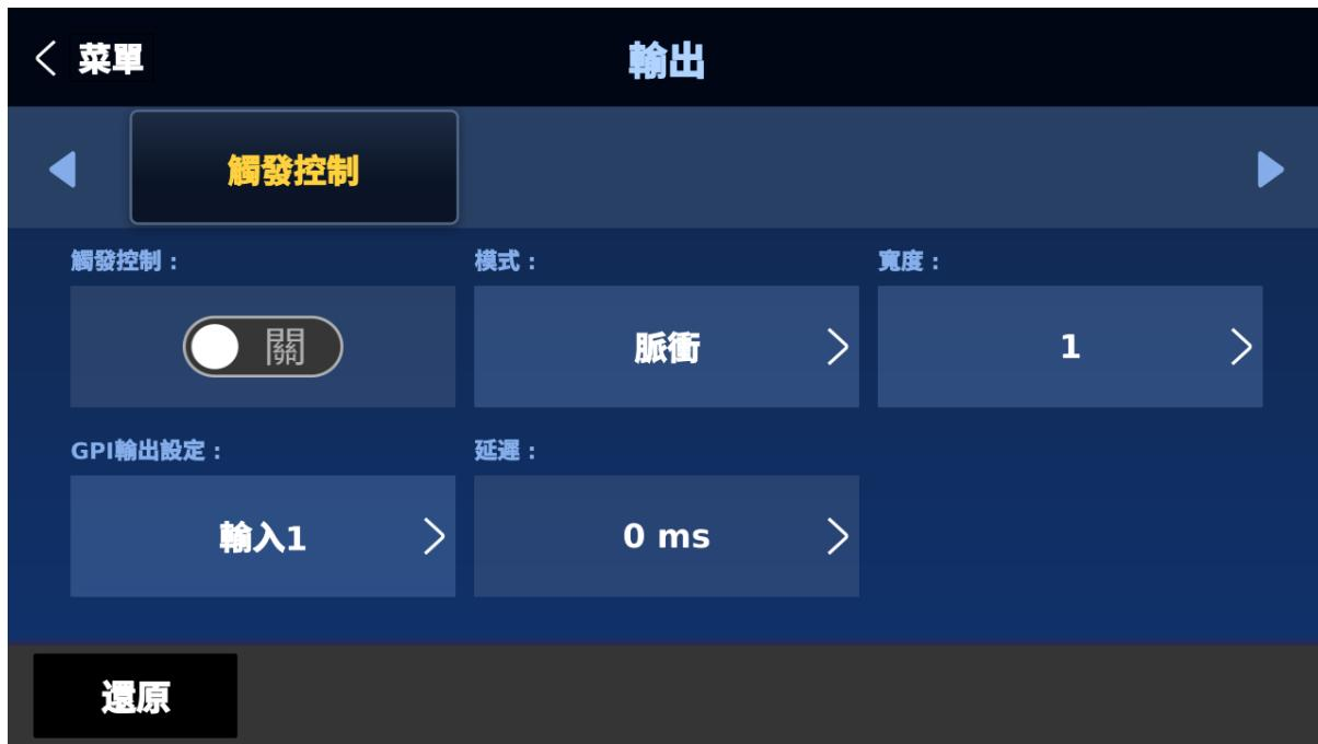
開啟觸發功能之後可選擇準位強度觸發(**Level**)或脈波寬度觸發(**Pulse**)模式。脈波寬度可在「**寬度**」子選項(1-9)設定。
