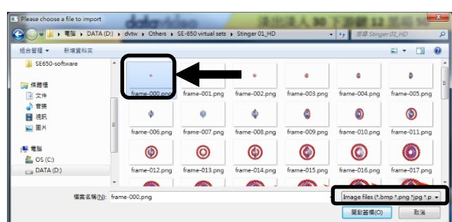
點擊「開啟舊檔」鍵可啟動動畫檔案匯入。若您的檔案不是 PIC 檔案格式，導播機多媒體檔案管理軟體會先自動轉換成 PIC 檔案格式。
