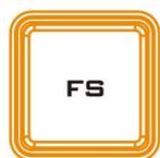
SE-2600 具備 8 組影像通道，每個通道都具備 Frame Store 圖片暫存器儲存圖片，因此可暫存高達 8 組圖片。FS 鍵(導播機鍵盤 Logo 鍵組的左方)可讓使用者來回切換圖片暫存器的靜態圖片和所對應之通道的實況影像。
