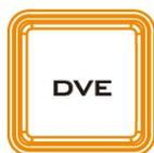
WIPE/DVE 鍵開啟主輸出和預覽畫面轉場時的 2D 擦拭(WIPE)或 3D 數位影像(DVE)特效。當手動推動 T-Bar 或按下 AUTO 鍵時即可產生擦拭或 3D 數位轉場特效。2D 擦拭(WIPE)特效在 OSD 選單→基本設定選設，亦可透過導播機鍵盤選設，3D 數位影像(DVE)特效則僅透過導播機鍵盤 DVE 1/2/3 按鍵選設。
