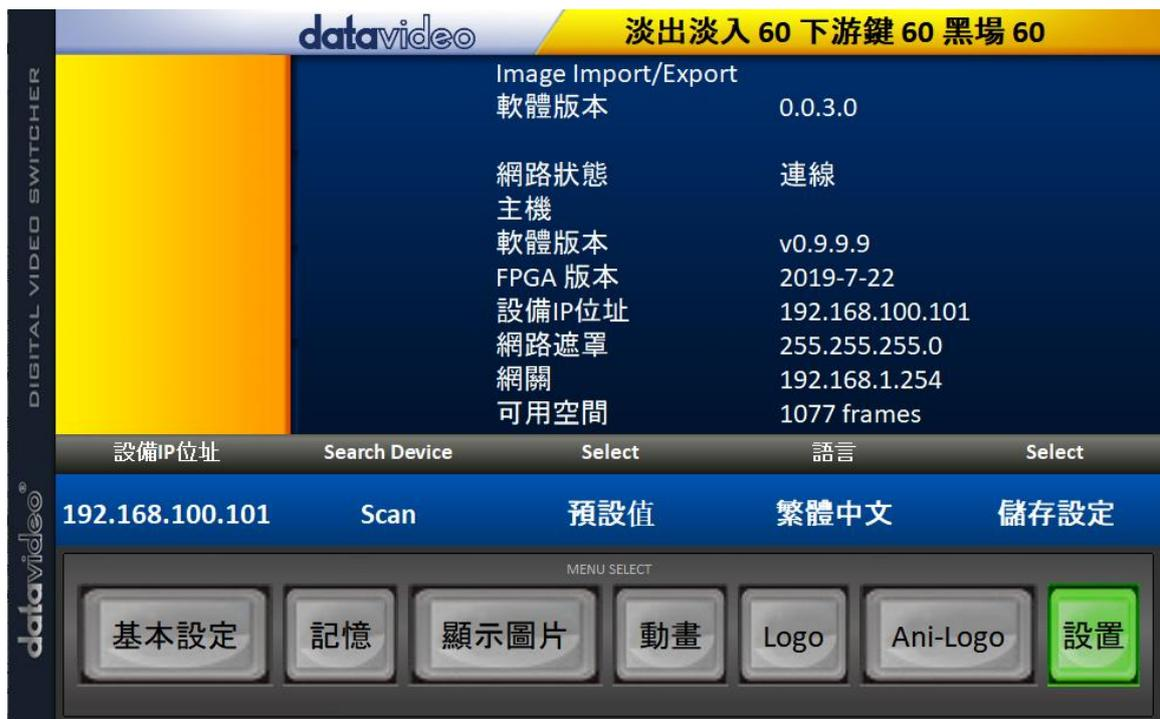
4. 點選**顯示圖片**鍵可預覽圖片並將電腦上的圖片檔案匯入到導播機。
