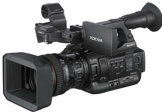
PXW-X200 是一款精巧型 XDCAM 攝錄影機，以三片 1/2 吋型 Exmor CMOS 感光元件提供高感光度和低雜訊錄影，支援 Full HD XAVC Intra 和 XAVC Long GOP，以及 MPEG HD 422 50 Mbps、MPEG HD 420 35 Mbps、MPEG IMX 和 DV。
